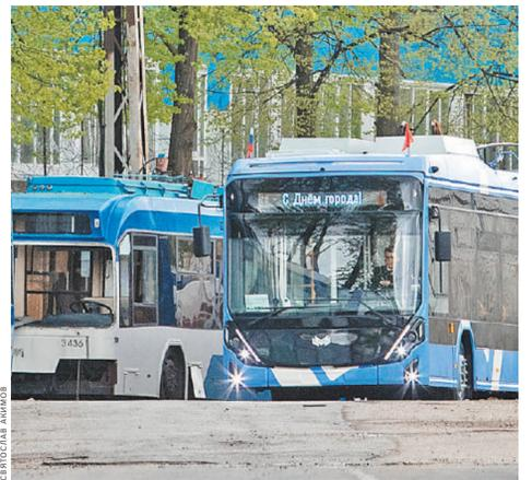
Троллейбусы на батареях могут проехать 20 километров без контактной сети.
