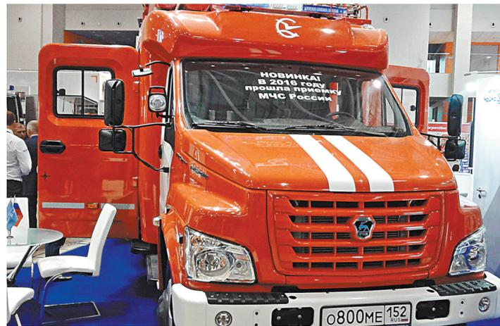
Пожарный автомобиль на шасси модели «Газон-Некст» может взять на борт до 2 тысяч литров воды.
