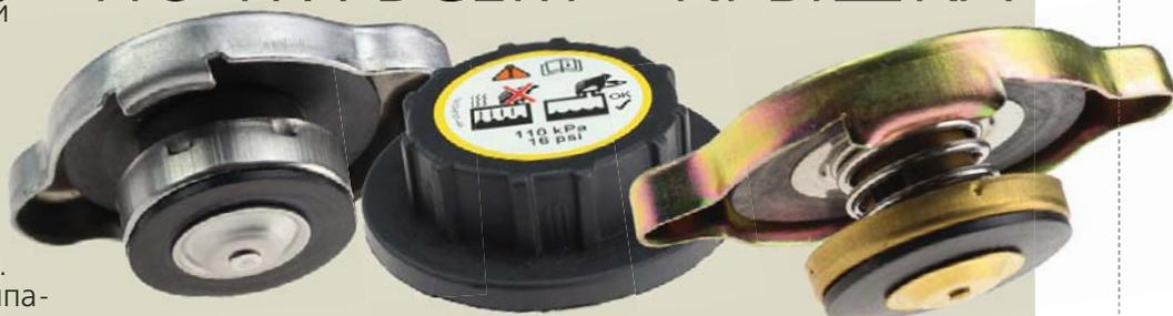
теристикам, которые обеспечиваются использованием определенных материалов для производства пружин внутреннего сжатия и уплотнений. Эти часто недооцениваемые компоненты обеспечивают стабильное рабочее давление в контуре охлаждения, предотвращают попадание в систему воздуха и позволяют сбрасывать избыточное давление.
