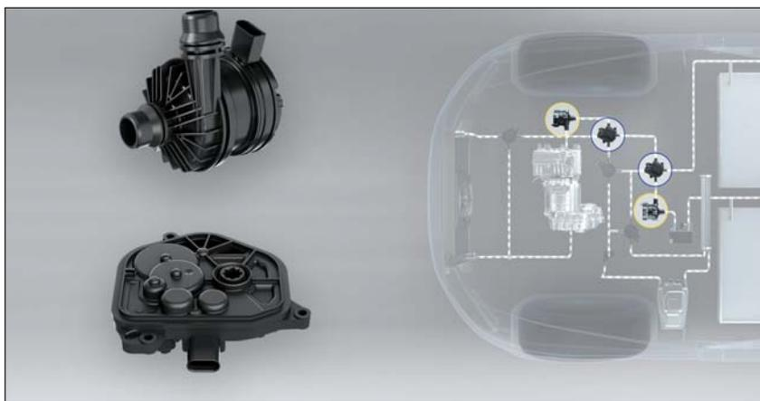
Являясь ключевыми компонентами системы управления температурным режимом, электронный привод клапана Hella, а также высокопроизводительный насос подачи жидкости обеспечивают циркуляцию жидкости через контур охлаждающей жидкости электромобиля и поддерживают оптимальный термический режим аккумуляторов и силовой электроники. Это позволяет увеличить срок службы и эффек-
