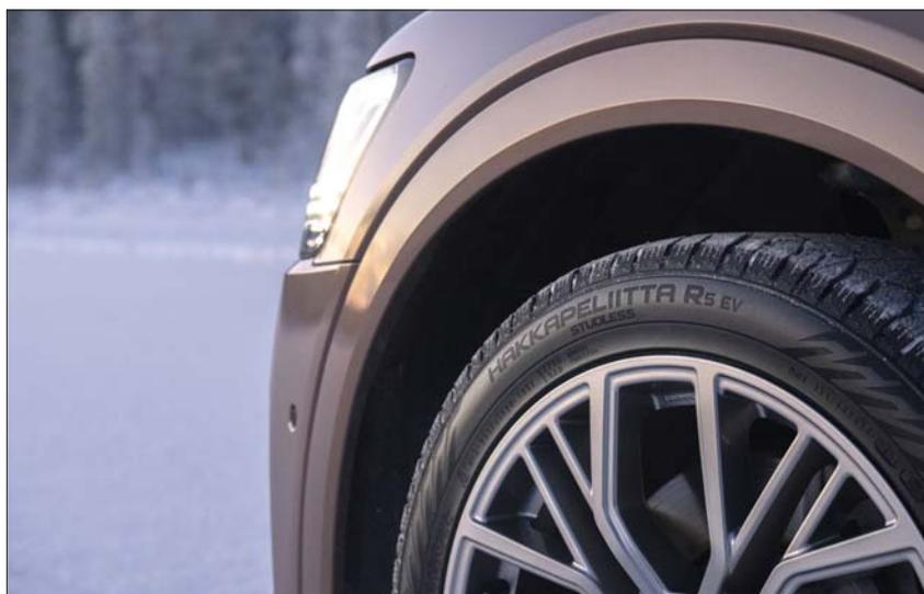
В версии шин для внедорожников применяется технология Aramid Sidewall, суть которой состоит в усилении боковин шины арамидными волокнами. Это делает шину более устойчивой к ударам и порезам.
